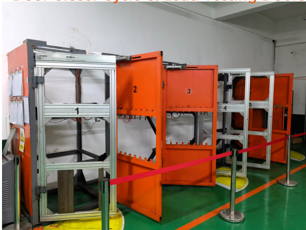
闭门器寿命&负载测试机 Door Closer Cycle & Load Testing Doors
